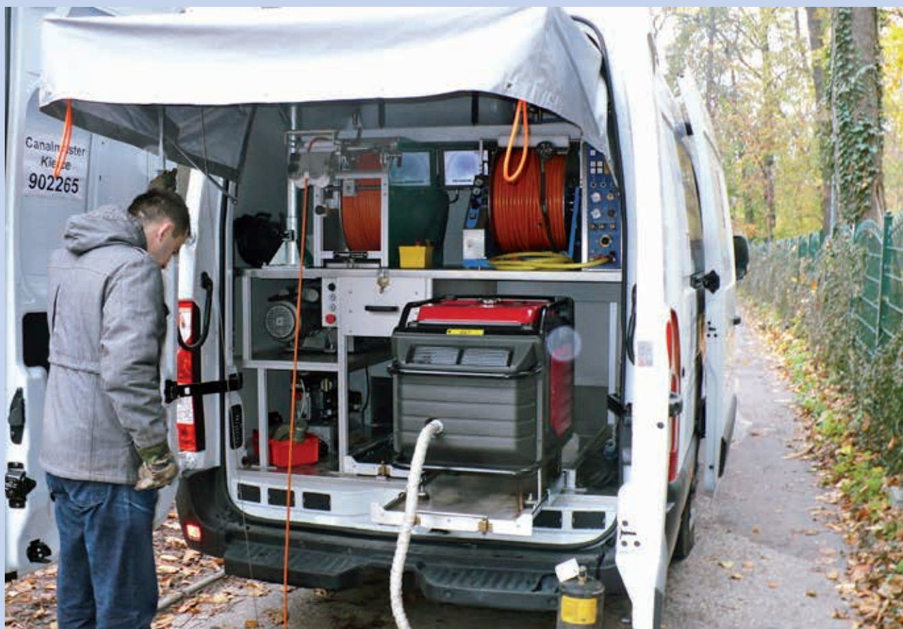
Ryc. 3. Urządzenie do inspekcji CCTV sieci kanalizacyjnej w wyposażeniu Pracowni Sieci i Instalacji Sanitarnych
